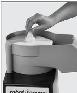
3) Engager le disque évacuateur en plastique blanc sur l'axe moteur et vérifier qu'il est bien positionné en fond de cuve.
